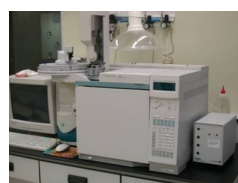
氣相層析儀-脈衝式火焰偵測器
